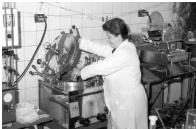
barvicí aparát CALBOT pro barvení různých typů textilních materiálů foto: J. Mlýnek
