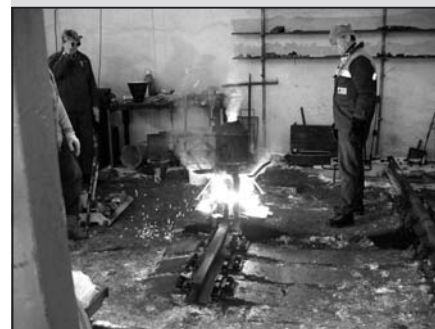
jedna z praktických ukázek svařování kolejnic
